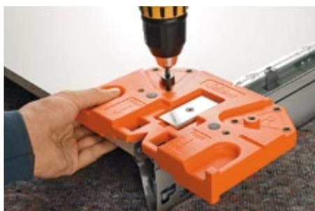
1. Установите сверлильный шаблон на установленном дне ящика и осуществите предварительное сверление позиций крепления для фиксатора.
