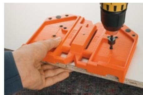
1. Отметьте середину ящика. Установите сверлильный шаблон в соответствии с разметкой и осуществите предварительное сверление позиций крепления для синхронизатора.
